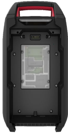
Figura 1-11: Conexão por satélite não instalada
